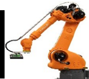
ピッキングロボット
